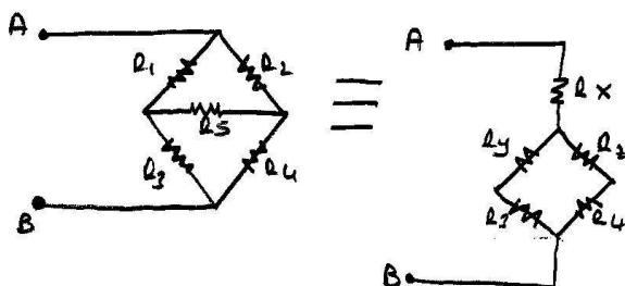
$$\begin{aligned} R_1 &= \frac{R_A R_C}{R_A + R_B + R_C} & R_A &= \frac{R_1 R_2 + R_1 R_3 + R_2 R_3}{R_2} \\ R_2 &= \frac{R_B R_C}{R_A + R_B + R_C} & R_B &= \frac{R_1 R_2 + R_1 R_3 + R_2 R_3}{R_1} \\ R_3 &= \frac{R_A R_B}{R_A + R_B + R_C} & R_C &= \frac{R_1 R_2 + R_1 R_3 + R_2 R_3}{R_3} \end{aligned}$$
